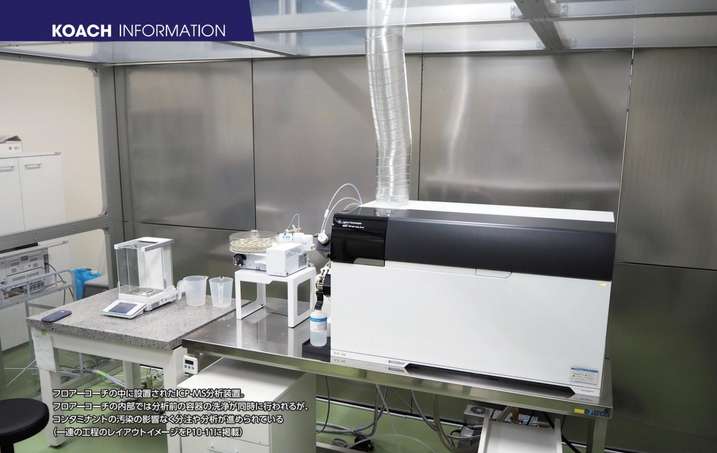
フローコーチの中に設置されたICP-MS分析装置。フローコーチの内部では分析前の容器の洗浄が同時に行われるが、コンタミナントの汚染の影響なく分注や分析が進められている（一連の工程のレイアウトイメージをP10-11に掲載）
