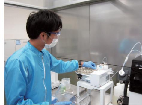
作成したサンプルをICP-MSで分析
